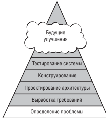
Рис. 3-4. Определение проблемы — фундамент всего процесса программирования
