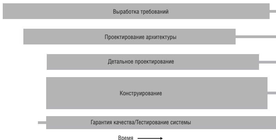
Рис. 3-3. В других случаях этапы перекрываются на всем протяжении проекта. Понимание степени выполнения предварительных условий и соответствующая адаптация проекта — одно из условий успешного конструирования
