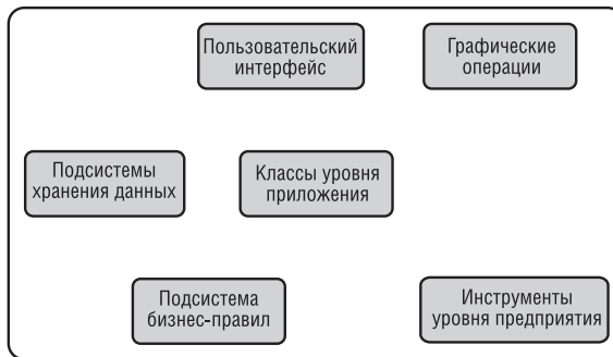
Рис. 5-3. Пример системы, включающей шесть подсистем
