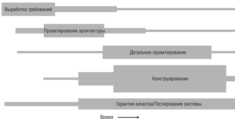
Рис. 3-2. Этапы работы над проектами — даже самыми последовательными — обычно несколько перекрываются
