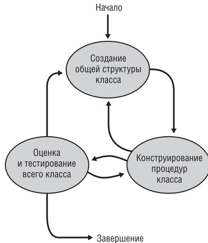
Рис. 9-1. Детали конструирования классов могут различаться, но обычно порядок действий такой
